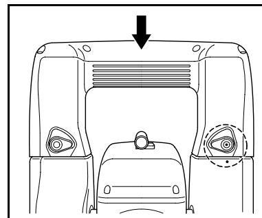
5. Установите клавиши крепления батареи в вертикальное положение (LOCK). Для этого поверните наружу каждую клавишу.
