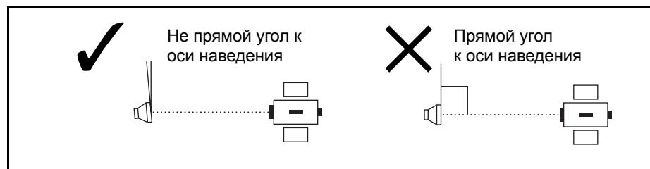
Держите призму ровно на одном месте и не двигайте, когда производите измерения. В режиме с отражателем, чтобы избежать ложных измерений от других объектов (а не от призмы или отражательной марки), не измеряются цели имеющие меньшую отражающую способность чем призма или отражательная марка. Даже если вы начали измерение, измеренные значения не отображаются. Для измерения целей с малой отражающей способностью используйте безотражательный режим.
