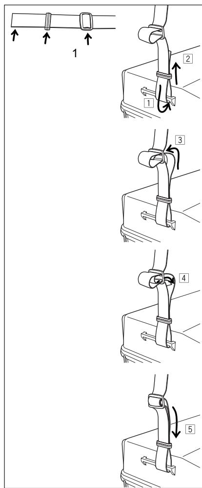
Рисунок 2.3 Крепление ремней к транспортировочному ящику инструмента
