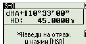
Когда измерение будет завершено, то на экране будет показана разница между текущим положением отражателя и требуемой точкой разбивки..
