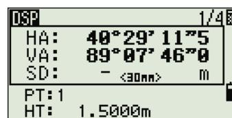
Если количество измерений для осреднения установлено равным 0, измерения будут продолжаться до тех пор, пока вы не нажмете клавиши **[MSR1]**, **[MSR2]**, или **[ESC]**. После каждого измерения значение расстояния обновляется.
