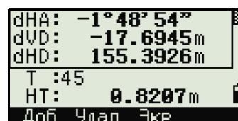
Если требуется удалить измерение (возможно из-за больших ошибок), установите курсор на ту точку, которую надо удалить, и затем нажмите программную клавишу Удал. После удаления, координаты станции будут автоматически пересчитаны.
