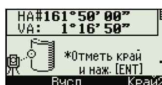
Если измерение расстояние было произведено до центра окружности, то достаточно сделать измерение только на одну границу окружности и нажать программную клавишу Вчсл для вычисления центра и радиуса.
