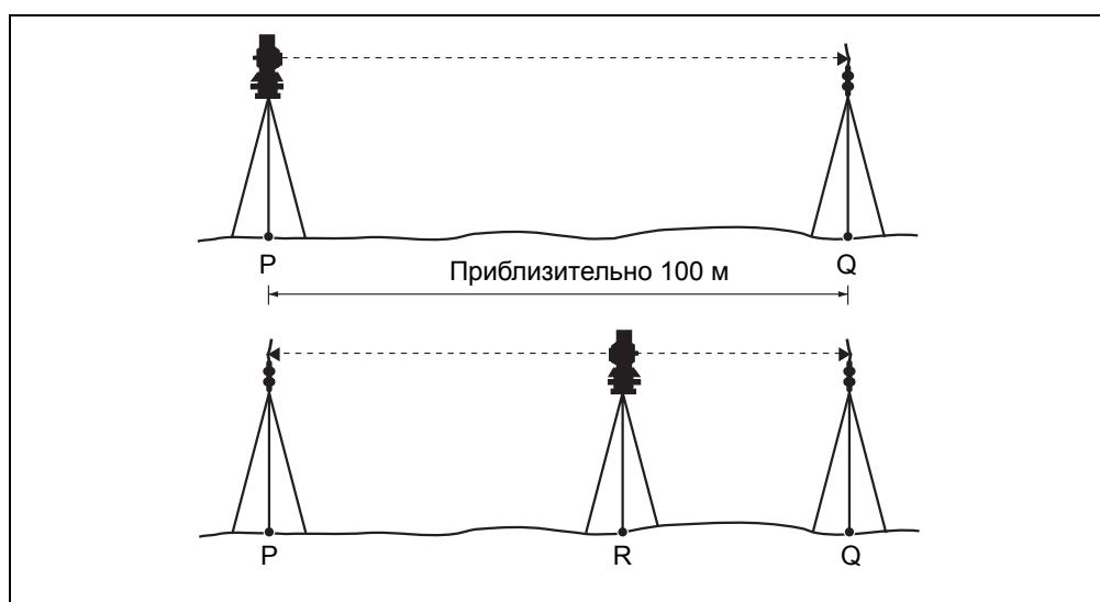
Для проверки постоянной инструмента:
