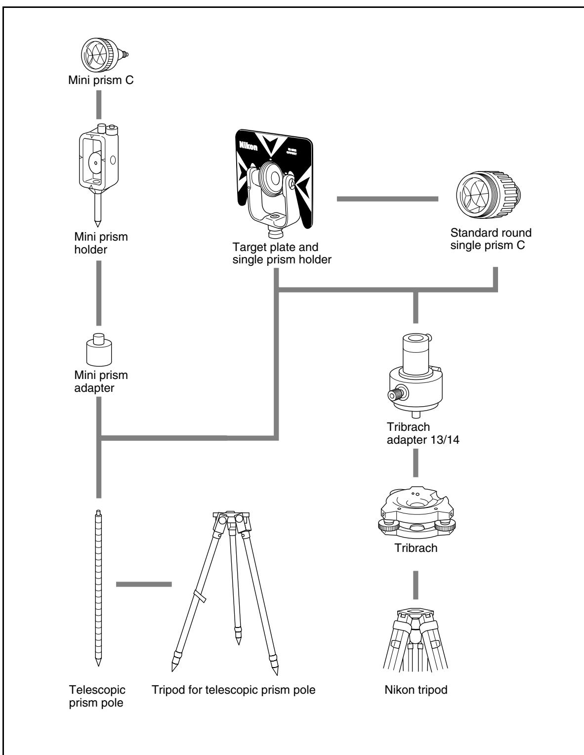
Рисунок 8.2 Компоненты призменного отражателя
