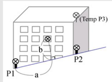
Как только плоскость будет определена, то значения a и b будут автоматически обновляться при перемещении зрительной трубы. При этом измерять расстояние не требуется.
