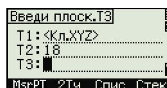
В случае, если плоскость определяется двумя точками (выбором [2ТЧ]), то работа функции будет аналогична функции V-плоск но будут отображаться следующие величины: Sta и dZ, а не a и b. Подробная информация приведена в разделе [Измерение расстояния и смещения в вертикальной плоскости, стр. 91.](#)
