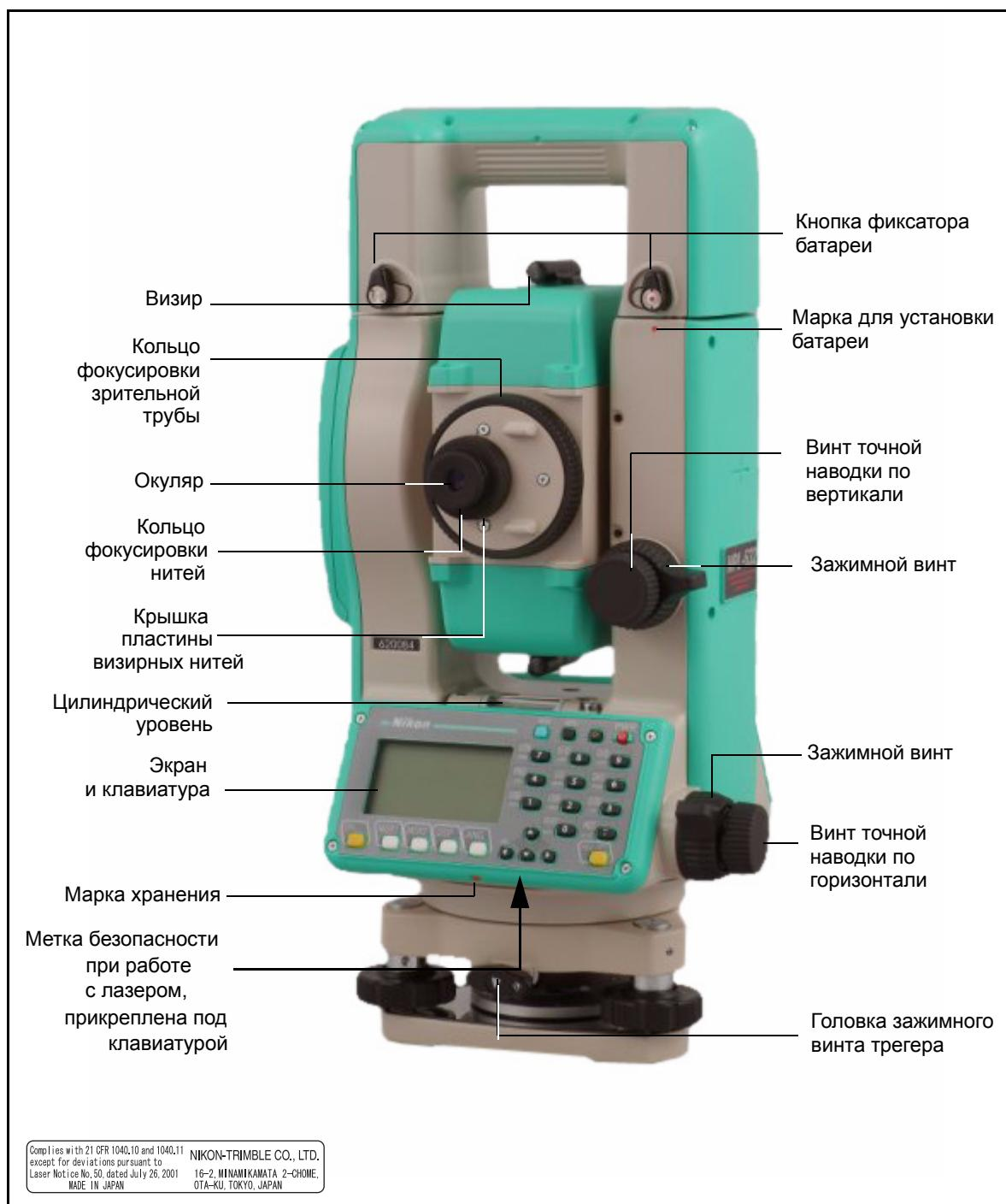
Рисунок 1.1 Электронный тахеометр NPL-632 – Сторона-1
