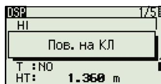
Чтобы настроить ГК с использованием КЛ/КП измерения, задняя точка также должна быть измерена в режиме КЛ/КП в процессе установки станции
