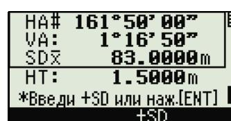
Если используется призма, приставляемая к поверхности цилиндра на расстоянии измерения, нажмите программную клавишу "+SD" для устранения ошибки смещения (от точки соприкосновения до измеряемой поверхности призмы) перед нажатием **[ENT]**.
