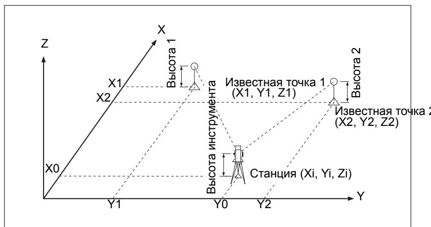
Вы можете использовать максимум 10 точек для засечки. Можно производить измерения как углов и расстояний, так и только углов. Вычисление производиться автоматически, как только будет сделано необходимое количество измерений.
