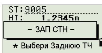
Для вычисления засечки должны быть произведены измерения углов минимум на 3 точки или одно угловое измерение и одно измерение расстояния и угла.
