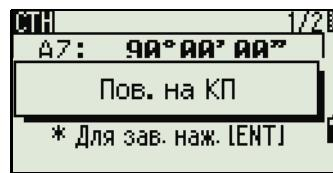
После того как вы произвели измерение расстояния на ЗТ при КЛ, Вы можете просто перевести зрительную трубу на КП для измерения при Круге вправо. Инструмент автоматически определяет положение КЛ/КП .
