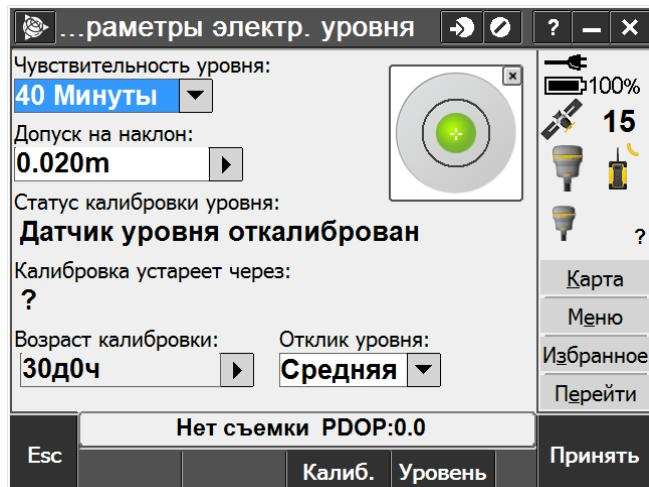
Отредактируйте настройки, выбирая цену деления уровня, допуск для наклона вехи (в проекции на плоскость)
