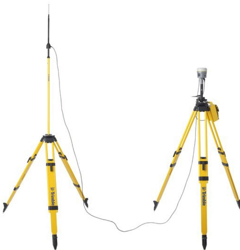
**Приемник с внешней радиоантенной**
