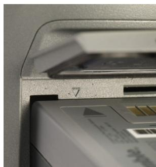
**Примечание** – Уплотнительная резинка на внутренней стороне крышки аккумуляторного отсека должна быть очищена от грязи и пыли для обеспечения надлежащей герметизации батарейного отсека.
