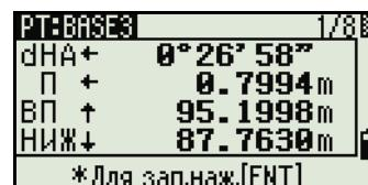
Для переключения между экранами **[DSP]**. Эта функция работает так же, как для разбивки по углу и расстоянию, за исключением того, что счетчик экранов (например, S-01/8) не отображается. Дополнительная информация приведена в разделе [Использование клавиши \[DSP\] для переключения между экранами, стр. 73.](#)
