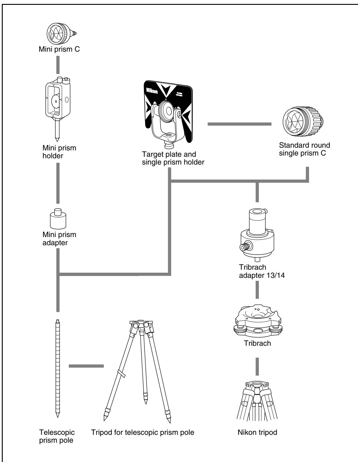
Рисунок 8.2 Компоненты призменного отражателя
