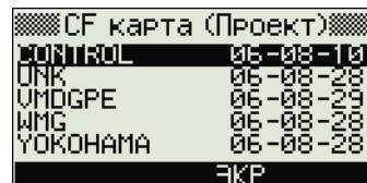
Если обе карты, CompactFlash и USB, установлены в инструменте, будет отображаться только содержимое карты памяти USB.
