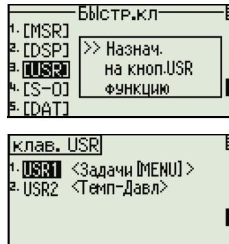
Имеется две клавиши [USR]. Функции, присвоенные каждой из клавиш, написаны позади имени клавиши.
