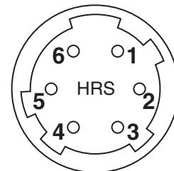
При присоединении внешнего источника питания, питающее напряжение подается на 3 контакт (вход питания) и 5 контакт (земля) на инструменте. Инструмент будет использовать внешний источник питания, если к нему присоединена переносная батарея BC-80.
