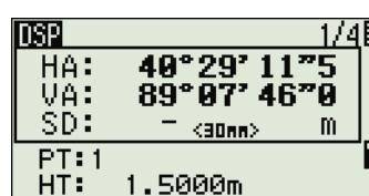
Если количество измерений для осреднения установлено равным 0, измерения будут продолжаться до тех пор, пока вы не нажмете клавиши **[MSR1]**, **[MSR2]**, или **[ESC]**. После каждого измерения значение расстояния обновляется.
