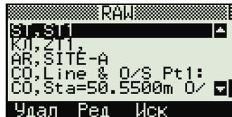
Все поля в записи ST могут быть отредактированы, но никаких перевычислений инструмент не производит.
