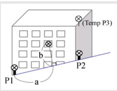
Как только плоскость будет определена, то значения a и b будут автоматически обновляться при перемещении зрительной трубы. При этом измерять расстояние не требуется.
