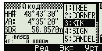
Нажмите **MODE** для включения/выключения режима Q-кодов.
