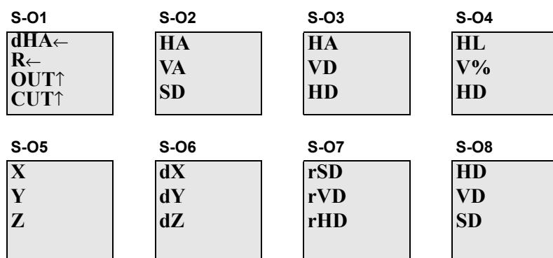
Экран S-08 доступен только в том случае, если установлены вторые единицы измерения расстояния. Дополнительная информация приведена в разделе [Прочие параметры, стр. 125](#).
