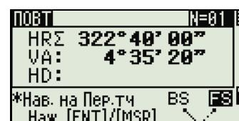
5. Когда вы накопите достаточное количество измерений горизонтального угла между задней и передней точками, произведите измерение на переднюю точку, нажав [MSR1] или [MSR2].
