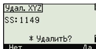
Удаление координат может быть также выполнено при просмотре детальной информации по точке. Нажмите программную кнопку Удал.
