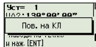
Допуск при считывании угла для каждого направления равен 10''. Чтобы сохранить точность инструмента, необходимо сделать измерения с большой аккуратностью. Если dHA в любом направлении более 10'', появляется сообщение об ошибке. При этом вы должны и вы должны перемерить все три набора точек.
