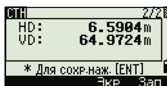
Если вы определяете линию путем ввода координат T2, будут показаны разности горизонтального проложения (dHD) и вертикального расстояния (dZ) между измеренными и введенными вами данными.
