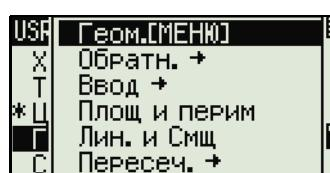
Чтобы присвоить определенную функцию из подменю, нажимайте клавиши курсора [↑] или [↓] чтобы выбрать имя нужной функции. Затем нажмите [ENT].
