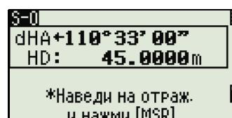
Когда измерение будет завершено, то на экране будет показана разница между текущим положением отражателя и требуемой точкой разбивки.
