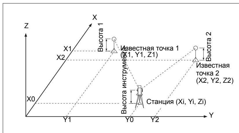
Вы можете использовать максимум 10 точек для засечки. Можно производить измерения как углов и расстояний, так и только углов. Вычисление производиться автоматически, как только будет сделано необходимое количество измерений.
