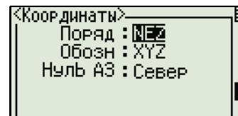
Параметры Порядок и Нуль AZ в проекте могут быть установлены только при его создании.
