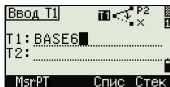
В стеке содержатся имена последних 20 использованных точек. Они отображаются в хронологическом порядке, начиная с последней использованной точки.
