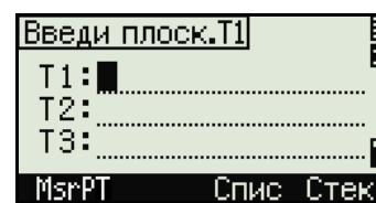
Если нажать клавишу **ENT** в пустом поле, появится экран ввода временных координат. Эти координаты не записываются в память прибора.
