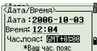
Временная зона определяется из операционной системы. Вы должны правильно установить временную зону перед использованием системы. Если этого не сделать, время, сохраняемое на съемной памяти (CF и USB картах) будет отличаться от времени, отображаемого на инструменте.
