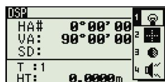
Иначе выберите необходимый переключатель, нажимая **[A]** или **[V]**. Затем нажмите **[ENT]** для переключения параметров выбранного переключателя. Например, для регулировки яркости, нажмайте **[A]** или **[V]** пока не будет выделен переключатель яркости. Затем нажмайте клавишу **[ENT]** пока не добьетесь необходимого уровня яркости.
