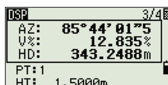
Когда установлены вторичные единицы измерения для расстояний, становится доступным дополнительный экран. На нем показаны величины ГК, ВК и SD. Информация об установке вторичных единиц измерения для расстояний приведена в соответствующем разделе, см. [страница 125](#).
