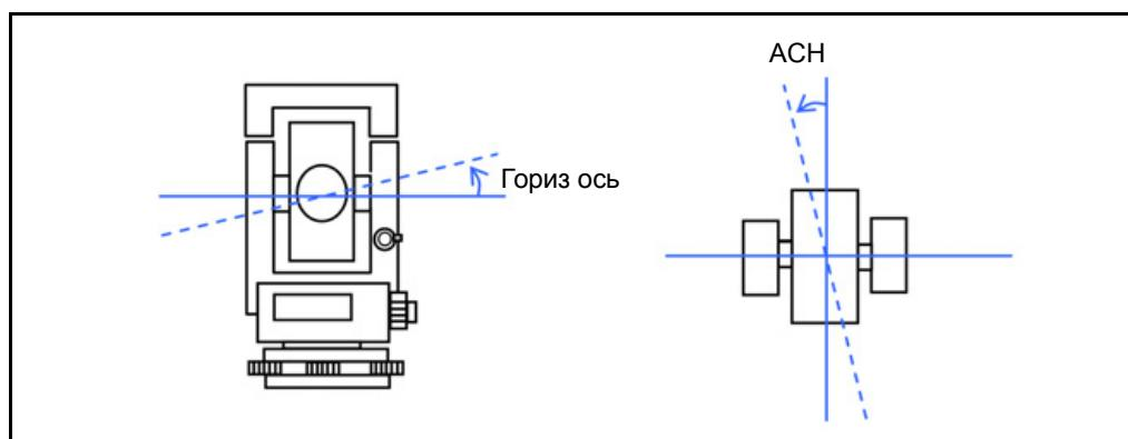
Поскольку величина компенсации соответствует вертикальному углу, при применении компенсации прибор слегка изменяет горизонтальный угол, даже когда вы затянули зажимной винт.
