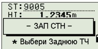
Для вычисления засечки должны быть произведены измерения углов минимум на 3 точки или одно угловое измерение и одно измерение расстояния и угла.
