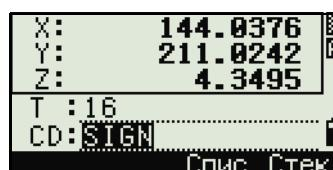
Как только плоскость будет определена, то значения Sta/dZ будут автоматически обновляться при перемещении зрительной трубы. При этом измерять расстояние не требуется.
