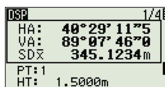
Пока прибор делает измерение, постоянная призмы отображается мелким шрифтом.
