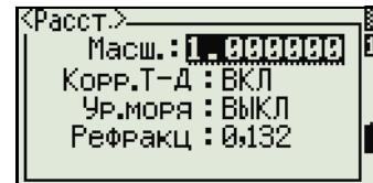
Параметры масштаба, коррекции Т-Д, поправки за уровень моря и за кривизну и рефракцию земли в проекте могут быть установлены только при его создании.
