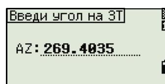
При нажатии на клавишу **[ENT]** без ввода азимута в поле AZ будет автоматически установлено значение  $0^{\circ}00'00''$ .
