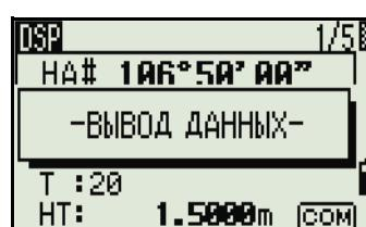
Для вывода данных на COM порт при нажатии на **[ENT]** необходимо установить значение COM в поле Запись **МЕНЮ > Установки > Запись**. Дополнительная информация приводится в разделе [Запись, стр. 124](#).
