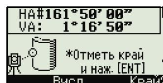
Если измерение расстояние было произведено до центра окружности, то достаточно сделать измерение только на одну границу окружности и нажать программную клавишу Вчсл для вычисления центра и радиуса.
