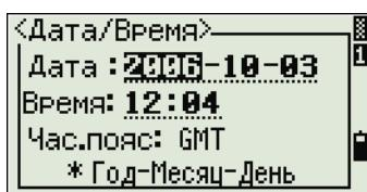
Если выделенная часть поля верна (например, год), вы просто можете нажать **[ENT]**, чтобы использовать текущее значение. Например, если установлена дата Июнь 24, 2002 г., а вы хотите изменить ее на Июнь 18, 2002 г., нажмите **[ENT] [ENT] [1] [8] [ENT]**.
