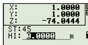
Когда высота инструмента HI изменяется, координата Z обновляется до записи станции. Установка станции должна быть завершена перед использованием функции Высотной привязки.
