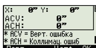
Если в поле НА корр установлено значение Нет, параметр ACH не будет применяться для отсчетов горизонтального угла. Если в поле НА корр установлено значение Да, параметры ACH и параметры коррекции наклона горизонтальной оси будут применены для горизонтального угла. Если вы не выполнили второй этап, параметры коррекции наклона горизонтальной оси будут установлены в 0 и будут применяться только параметры ACH. Подробнее об этом смотрите в разделе [Угол, стр. 120](#).
