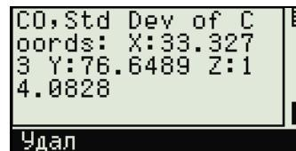
Если вы вводите координаты станции при помощи функции База XYZ, запись станции отображается в виде комментариев.
