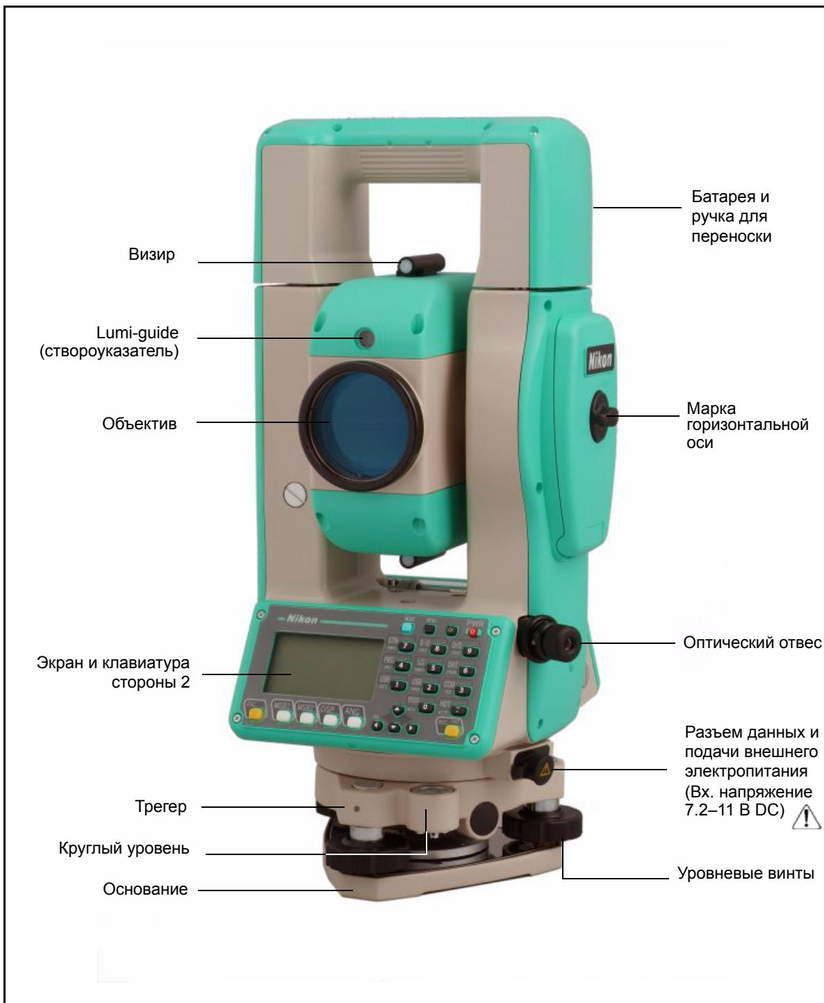
Рисунок 1.2 Электронный тахеометр DTM-652 – Сторона-2
