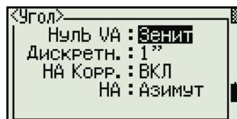
Параметр Нуль VA в проекте может быть установлен только при его создании.
