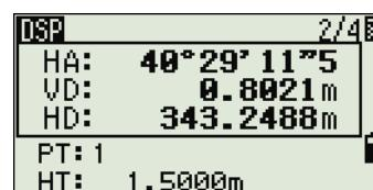
Например если отображается экран DSP2 нажмите [DSP] для переключения к экрану DSP3. Индикатор экранов изменится с 2/4 на 3/4.
