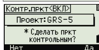
Если контрольный проект уже назначен, вновь назначенный проект заменит его в качестве контрольного. Для того чтобы отменить контрольный проект установите курсор на него, и вновь нажмите программную клавишу Ктрл. Затем нажмите **[ENT]** или программную кнопку **Да** для подтверждения.
