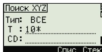
Поиск может быть выполнен по типу точки. Установите курсор в поле Тип и используйте клавиши курсора [←] или [→] для выбора нужного типа записи. Доступны типы: ВСЕ, MP, UP, CC, и RE.
