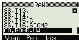
Удерживайте клавишу [DAT] в течение одной секунды чтобы появился экран Выбор формата. Используйте этот экран для изменения типа данных, назначенных для клавиши [DAT]. Нажмите [1] или выберите DAT [MENU] чтобы меню Данные отображалось каждый раз после нажатия клавиши [DAT].
