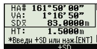
Если используется призма, приставляемая к поверхности цилиндра на расстоянии измерения, нажмите программную клавишу "+SD" для устранения ошибки смещения (от точки соприкосновения до измеряемой поверхности призмы) перед нажатием **[ENT]**.
