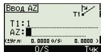
В поле "Угл" вводится положительное значение, если угол отсчитывается по часовой стрелке и отрицательное, если против часовой стрелки.
