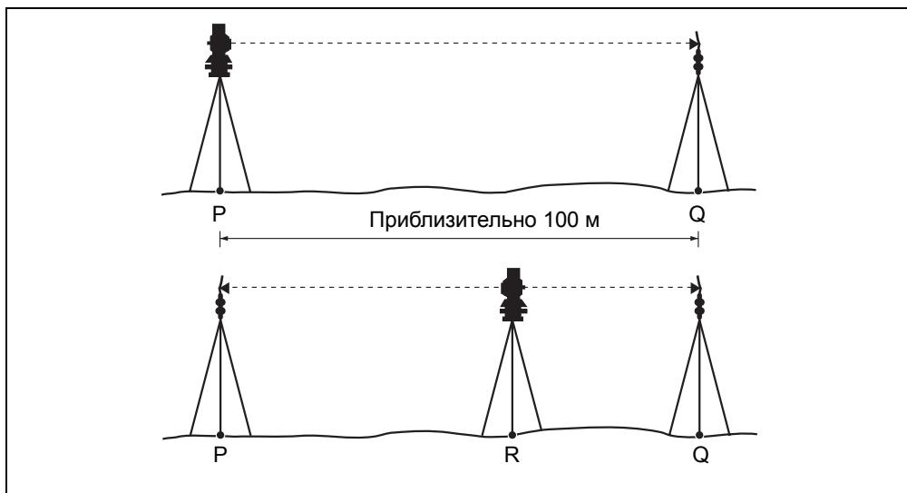
Для проверки постоянной инструмента:
