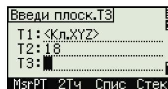
В случае, если плоскость определяется двумя точками (выбором [2ТЧ]), то работа функции будет аналогична функции V-плоск но будут отображаться следующие величины: Sta и dZ, а не a и b. Подробная информация приведена в разделе [Измерение расстояния и смещения в вертикальной плоскости, стр. 86](#).
