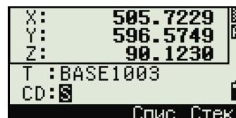
Используйте поле Доб.ТЧ в МЕНЮ > Установки > разбивка для определения целого числа, которое будет добавляться к номеру выносимой точки чтобы создать новый номер для записи выносимой точки. Значение по умолчанию равно 1000. Например, при разбивке точки ТЧ3 с таким значением, запись точки разбивки будет с номером 1003. Дополнительная информация приведена в разделе [Разбивка, стр. 123.](#)
