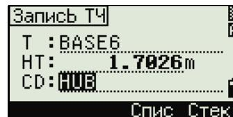
Для обозначения слоев применяется стрелка в конце метки кода. Если после выбора слоя вы нажмете **[ENT]**, будут отображены коды и слои из этого слоя.
