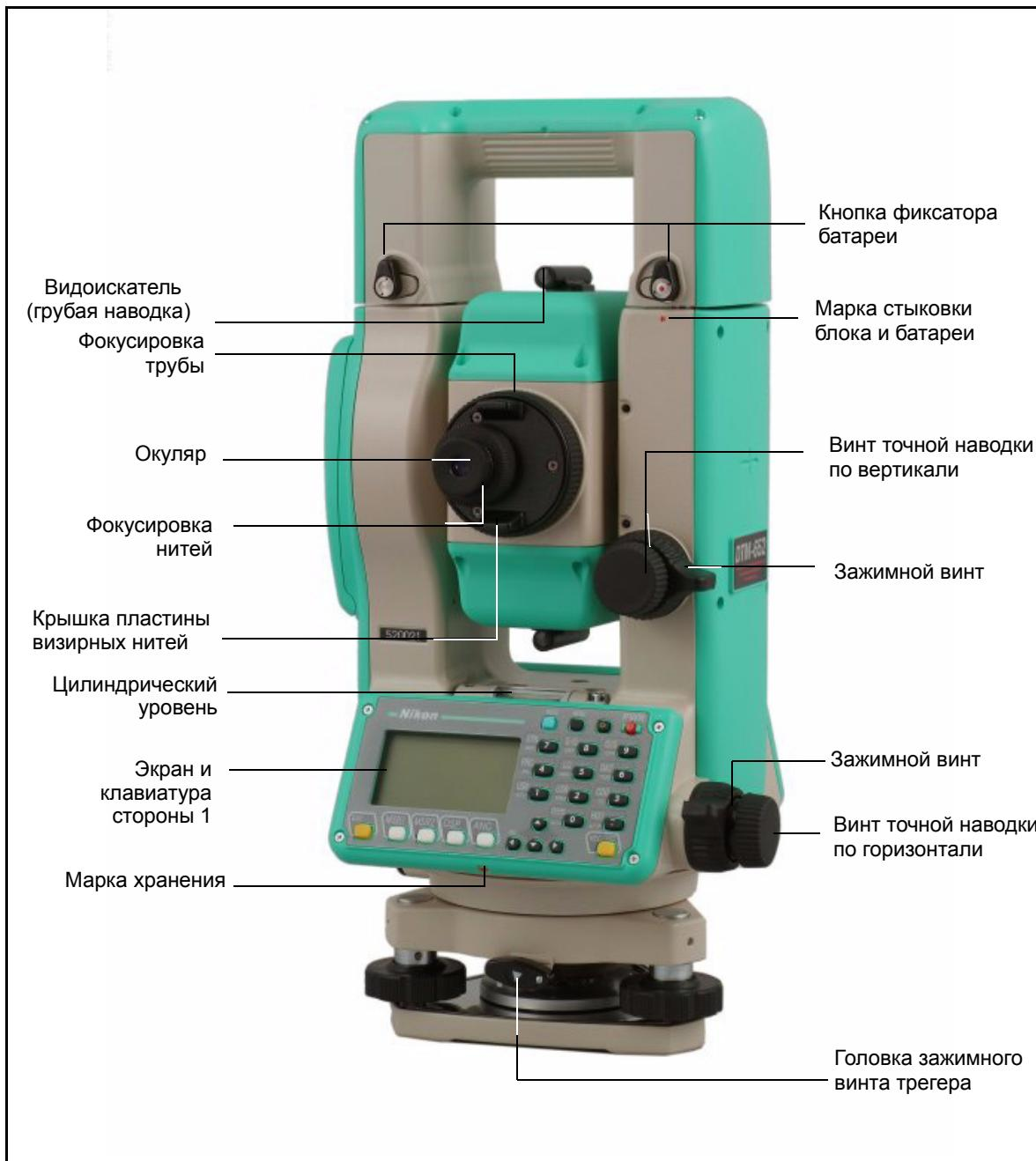
Рисунок 1.1 Электронный тахеометр DTM-652 – Сторона-1
