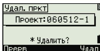
Для удаления текущего проекта нажмите ④. Для возврата к главному экрану измерений без удаления текущего проекта нажмите [ESC] или выберите программную клавишу Прерв.
