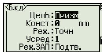
При измерениях Быстрых кодов режим записи может быть установлен только как "Подтв." или "ВСЕ".
