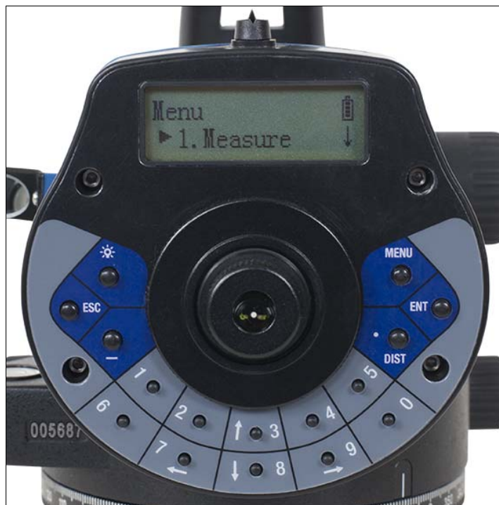
Рисунок 3.1 Органы управления и дисплей цифрового уровня DL-15.
